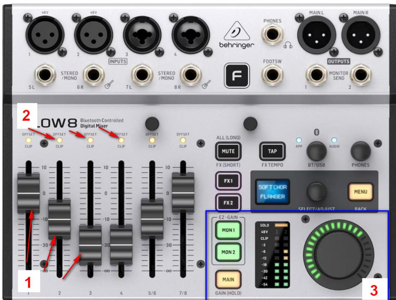
**Beispiel:** Eingang 1, das Mikrofon der Kanzel ist zu leise oder laut. Wir drücken die Taste **MON** und bewegen den **Schieberegler 1** nach oben oder unten – damit werden die vorderen Lautsprecher eingestellt. Dann drücken wir **MAIN** und bewegen den Regler um die hinteren Lautsprecher einzustellen.
