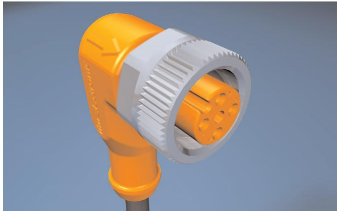
Verbinden Sie den Steckverbinder mit dem Sensor, der Pfeil zeigt die richtige Lage der Kodierung. Um die angegebene Schutzart zu gewährleisten, muss die Überwurfmutter mit einem Anzugsdrehmoment von 0,6 Nm (handfest) bis 1,5 Nm (Schlüsselmontage) angezogen werden.
