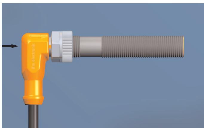
Beim Einsatz in rauen Umgebungen ziehen Sie die Überwurfmutter mit einem Schlüssel (SW14) eine Raste weiter fest, um Schock- und Vibrationsfestigkeit zu erhöhen. Zur Demontage verwenden Sie ebenfalls einen Schlüssel (SW14).
